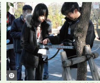
⑫ デンドロメータを用いた樹木の年輪調査
