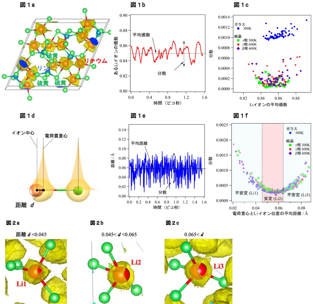
図1 : Bader 電荷分析法で評価した Li イオンの環境。(a)  $\text{Li}_2\text{S}-\text{P}_2\text{S}_5$  結晶の Bader 法から得られた Li イオンの電荷密度。(b) Li イオンの 1.6ps の間の平均価数振動と分散。(c) ガラス相<sup>※10</sup>、結晶  $\beta$  相、結晶  $\gamma$  相の Li イオンの平均価数と分散の相関。(d) Bader 解析で得られる距離情報。(e) 1.6ps 間の Li イオン位置と電荷雲重心の平均距離と分散。(f) ガラス相、結晶相各々の Li イオン位置と電荷雲重心の平均距離と分散の相関関係。
