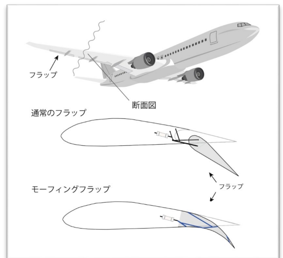
図 通常のフラップとイルカの尾びれのように滑らかな動きのモーフィングフラップの比較
