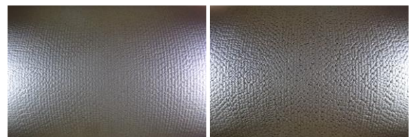
図2 等級1（左）と等級5（右）の鋳肌画像 これまでは経験を積んだ職人の目で分類を行っていた。
