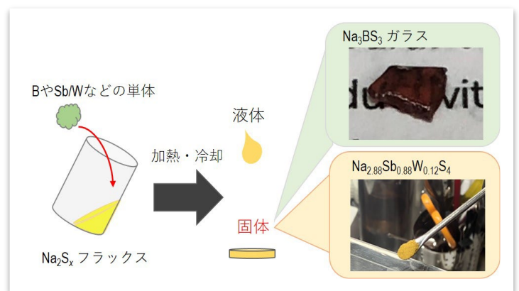
図1 多硫化ナトリウム ( \text{Na}_2\text{S}_x ) をセルフフラックスとして用いた合成プロセス
