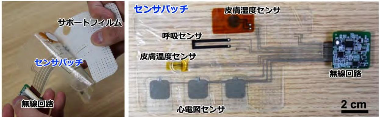
図 1. 開発したウェアラブルマルチモーダルセンサパッチ
