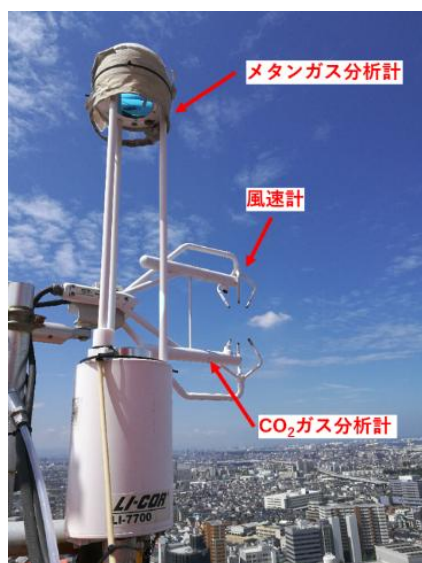
図1 堺市役所高層館屋上の電波塔に設置された都市域のメタンとCO 2 の排出量をモニタリングするための気象観測装置。365日、30分毎に、堺市中心部からの温室効果ガス排出量を連続的にモニタリングしている。
