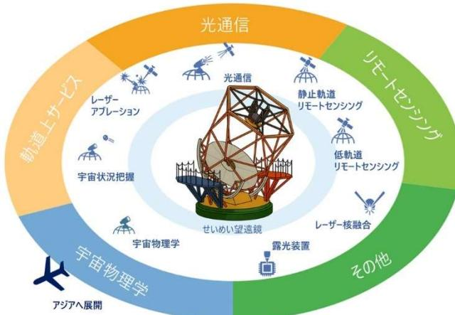
せいめい望遠鏡は、東アジア最大となる口径 3.8m を有する大型光学望遠鏡です。主鏡には、世界的にも稀な国内初の分割鏡方式が採用されました。18枚の分割鏡の位置がリアルタイムで約 50nm の精度で制御されることで、あたかも一枚鏡のような光学性能を維持しています。京都大学では、この主鏡を実現するための高精度な計測・加工技術を独自に開発し、国内最大規模の大型・高精度鏡の製造技術を確立してきました。近年これらの技術はリモートセンシングや光通信など、宇宙関連産業分野への応用可能性も注目されています。本講演では、せいめい望遠鏡の技術と、その産業応用の展望について説明します。
