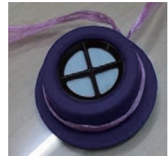
左：捕集装置のセッティング 右：大気汚染調査に用いたパッシブサンプラー
