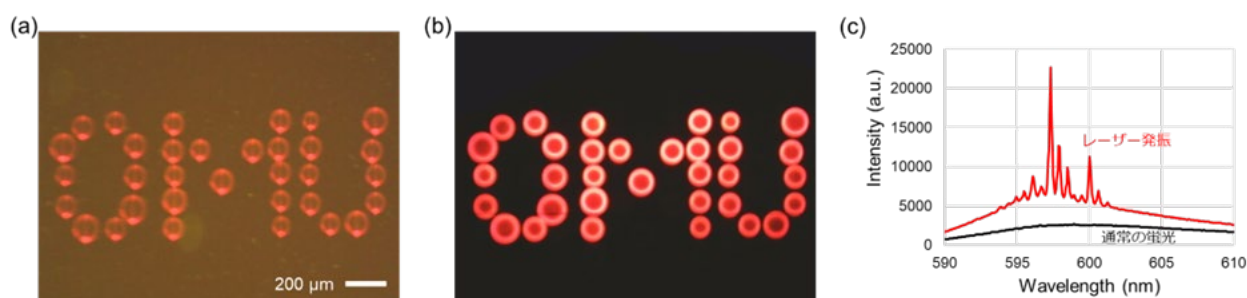
図 3 作製された「OMU」の(a)顕微鏡像と(b)蛍光像。(c)レーザー発振による蛍光スペクトル変化
