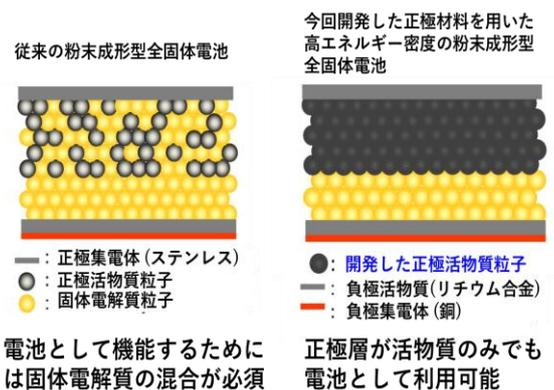
図1: 従来のバルク型全固体電池（左）と本研究で開発した高容量正極材料を用いたバルク型全固体電池（右）
