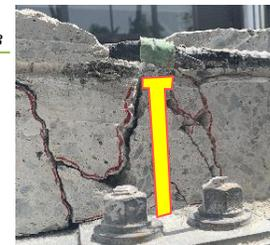
いずれのケースでも, すべりが生じ, 荷重停滞あるいは荷重低下が生じるまでは合成構造として挙動すると考えられます。SBケースでも安全率として1.7を見込めると考えられます (Fig.4) 一方, SB-HSケースでは頭付きスタッドの頭部周辺でひび割れが発生し (Fig.5) コンクリートの圧縮断面が減少することで, すべり荷重が若干低下します。
