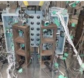
押し抜き試験
