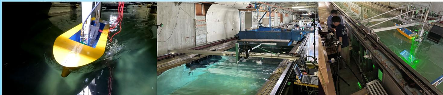
前進速度あり強制動揺試験 不規則波中運動&係留力計測 船外機周りの流場計測
