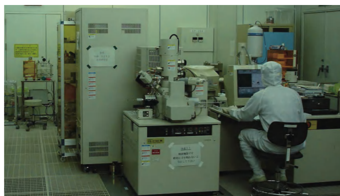
クリーンルームに設置されている収束イオンビーム装置
