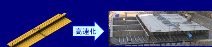
構造影響、溶接順序の影響、座屈等の全体変形、治具等の効果、多層溶接の影響等について検討可能になる
