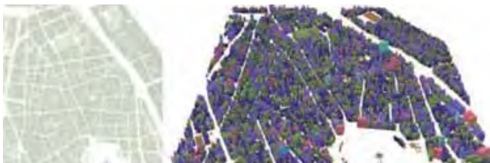
図3：建物のベクトルデータ（左）を3次元データ（右）に変換した可視化例。
