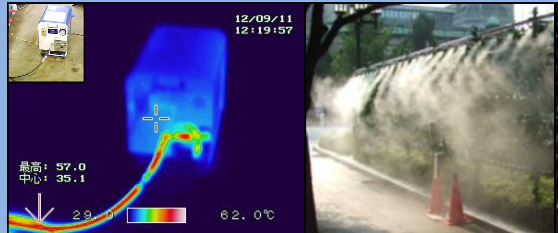
使用期間が長い場合、ポンプの排熱による配管中の水温が熱くなる。
