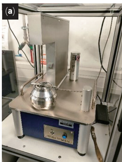
図1 (a)リングせん断試験、(b)乾式処理によるバインダーのフィブリル化、(c)カレンダーリング装置（すべてドライルーム（露点<-40度）で実施）
