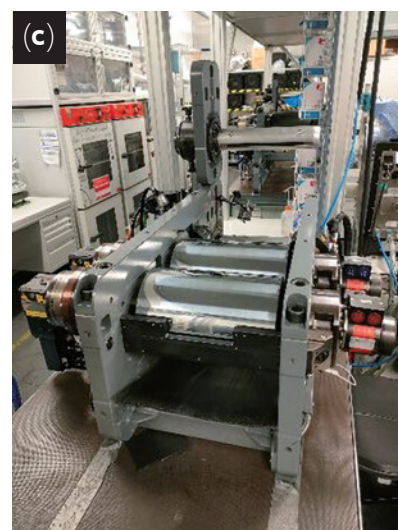
図1 (a)リングせん断試験、(b)乾式処理によるバインダーのフィブリル化、(c)カレンダーリング装置（すべてドライルーム（露点<-40度）で実施）
