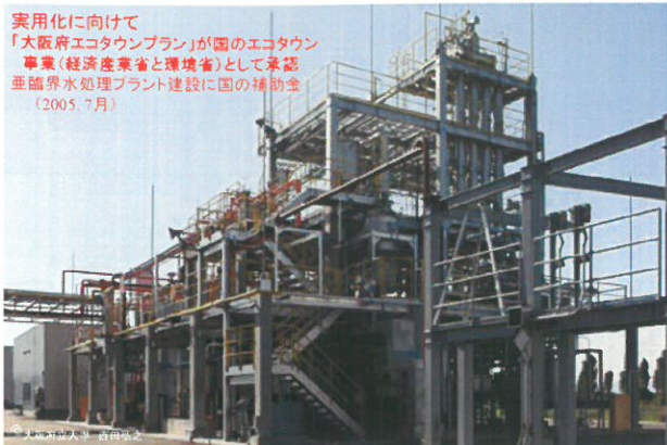
大阪エコタウンに建設された70トン/日の亜臨界水処理プラント(大阪府立大学COEプラントをスケールアップ) (近畿環境興産株式会社、塩素系有機溶剤の脱塩素化プロセス、現在商用運転中)
