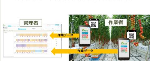
作業員に携帯させた端末を利用して、位置情報を二次元バーコード（QRコード）で入力することによって、作業速度および収穫量を記録することができる。また、圃場での情報（たとえば、病害虫）の写真を管理者に送信できる。
