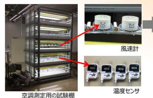
試験棚に各種センサを設置、風の流れと温度変化を測定、栽培環境の詳細データを取得してきました。
