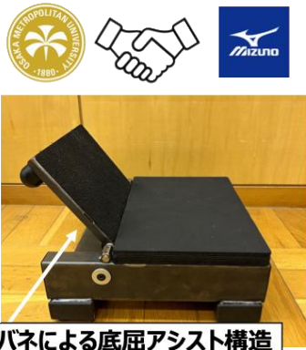
バネによる底屈アシスト構造
