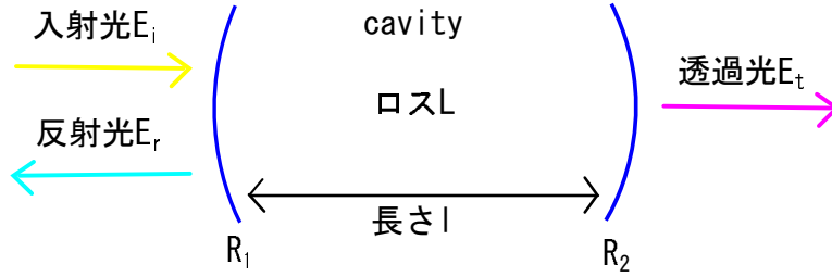
図 2.2 cavity の入射光、反射光、透過光を図のようにおく。ミラーの反射率は R_1 、 R_2 であり、共振器を一往復する時のロス を L とした。ミラーの分散は無視する。
