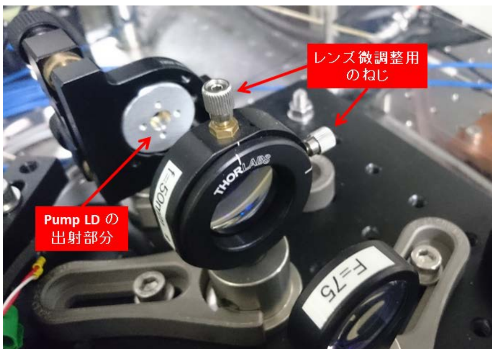
図 3.17 微調可能レンズホルダー 上と横のねじを回してレンズを微動させることができる
