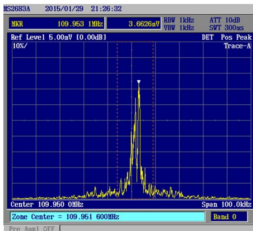
図 3.61 DPSS レーザーの出力 4.3 W での線幅 (VCO で 110 MHz)
