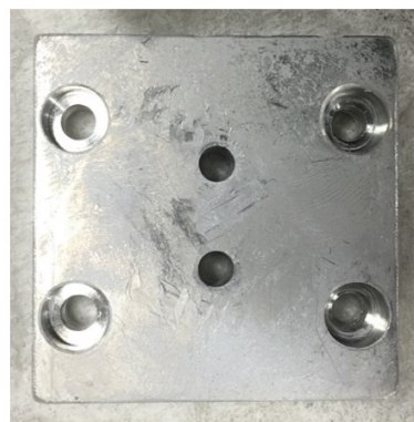
図 D.15 アルミの台 1 の設計図と実物の写真：材料にはアルミ合金（A2017）を、加工にはフライス盤を用いた。座繰り付きの穴は SM1C6 の底面に開けた穴と対応している。この部品は、アルミの台 2 とまとめて 1 つの部品としてもよい。
