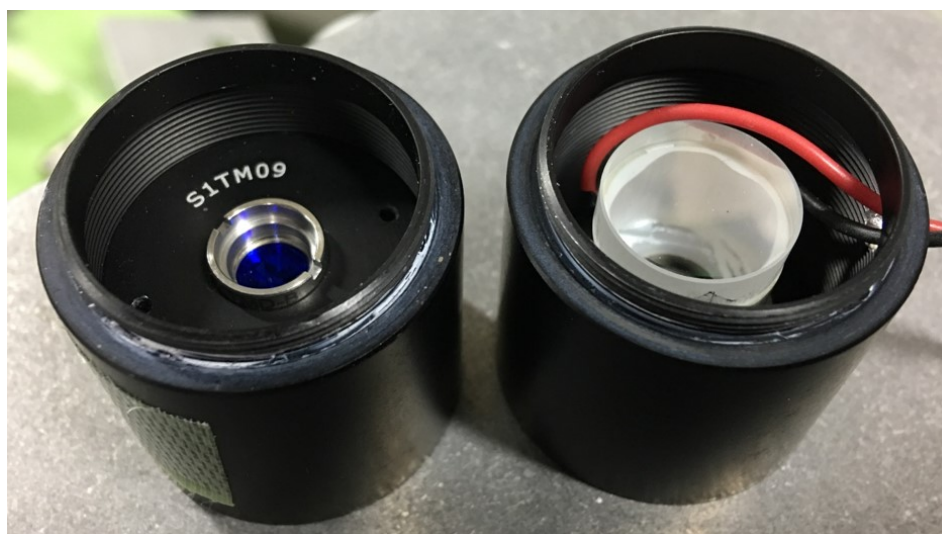
図 2.5 製作した Cateye (を分解したもの) の写真：この 2 つのレンズチューブ (黒い筒) を繋ぎ合わせることで Cateye となる。写真では見えないが、右側の筒の中には Cateye の出射側のレンズも入っている。PZT とミラーを接着したこと以外は既製品を組み合わせて製作している。レンズの焦点距離は 2 つとも f = 18.4\text{mm} 、ミラーの反射率は 0.3 のものを使用した。また、PZT は最大変位が使用する波長 (780nm) 1 波長分程度のものにした。写真に写っている赤と黒の銅線は PZT へと電圧を供給するためのものである。
