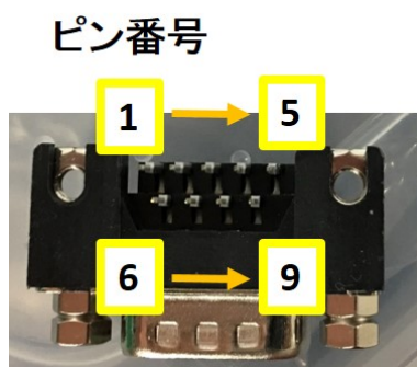
図 D.22 9 ピンコネクタのピン配置：実物にも番号が書かれているので、念のため確認しながらはんだ付けを行うこと。
