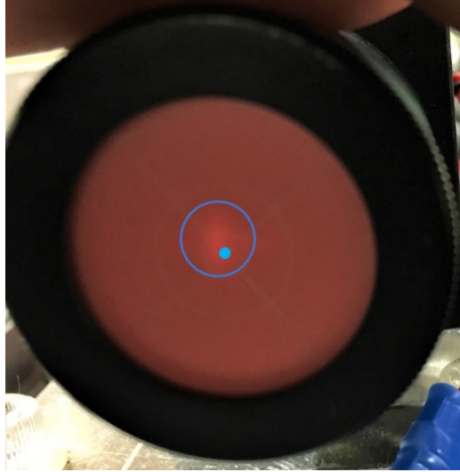
図 4.2 26mm のレンズチューブの先端にターゲットを付けたときの光の当たる位置：ターゲットの中心（写真中央の青点）と LD の出射光の中心（青丸で囲った少し明るい部分の中心）は約 1.0mm ずれている。LD の出射面からの距離は 64mm である。
