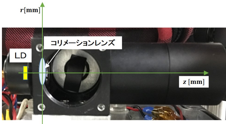
図 4.4 レンズチューブの中心軸からの光路のずれを求めるための z 軸の設定：LD とコリメーションレンズの間の距離は 4.5mm である。
