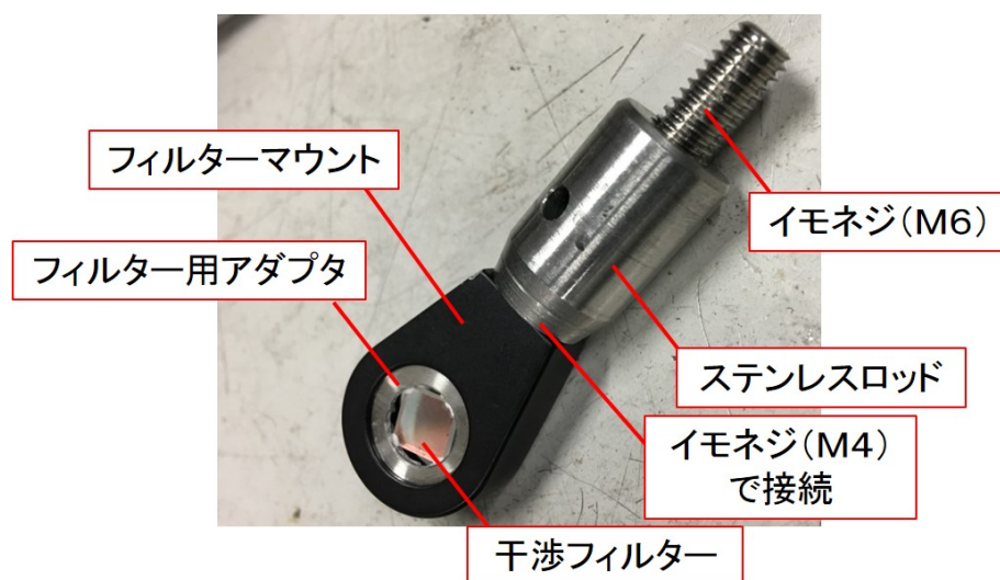
図 2.9 部品 1 の構成：写真では見えないが、フィルター用アダプタはフィルターマウントへはめ込んだ後、裏から固定リングによって抑えられている。
