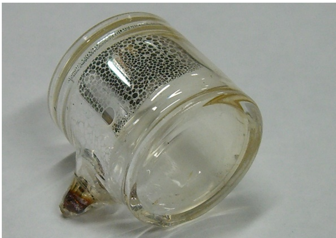
図 B.4: 金属を剥がしたガラスセル：金属が一部分だけに集まっている
