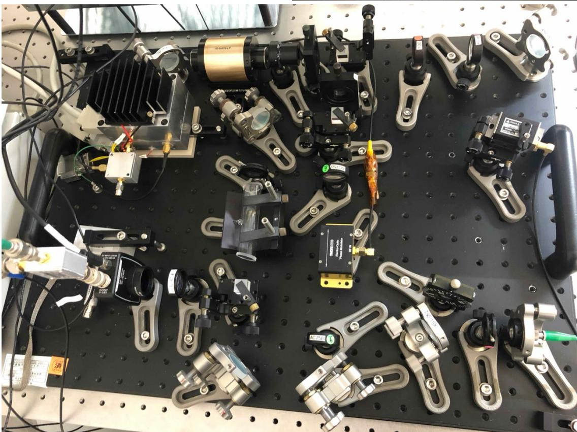
PhotodiodeはThorlabsのPDA8A2を用い、Mini-CircuitsのBias-Tee(ZFBT-4R2GW+)でRF信号とDCを作っている。DC信号の大きさは50オームの後でoffsetが1.5V、吸収信号が500mV程度であった。
