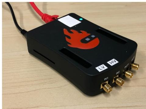
Red pitaya は高速な AD 変換を搭載した FPGA ベースのシングルボードコンピューターである。高周波信号の信号処理に優れ、安価で省スペース ("クレジットカードサイズ") なため、実験室における高周波信号処理に非常に適している。実際、MIT では Red pitaya を用いて FPGA ベースの NMR を作る授業が行われていることはよく知られている。
