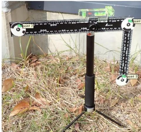
図 21 座標器へのポイント設定.
