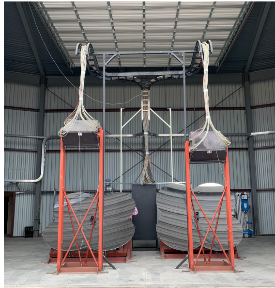
図 2.10: TALE FD の正面図 [9]。左側の望遠鏡は仰角 45^\circ から 59^\circ までの領域を観測し、右側の望遠鏡は仰角 31^\circ から 45^\circ までの領域を観測する。
