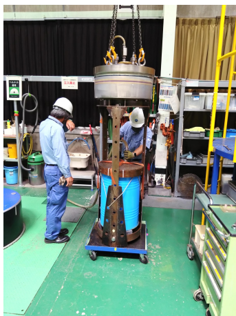
図 4.9 (a) 圧力試験の様子。ドラム缶に入れて水槽へ沈め、水圧をかけていく。(b) 上が圧力試験前のファイバー板 A、下が試験後のファイバー板 B。わずかに変形が生じている。
