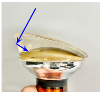
図 2.10 ゲルパッドによる反射の効果で検出効率が增加するイメージ図 [29]。
