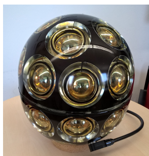
図 2.6 (a)mDOM の外観 ([26] より一部改変)。(b)mDOM の構成 [26]。
