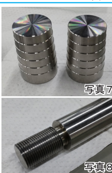
写真4・5：マシニングセンターを操る生産技術センター職員。 図2：旋盤加工のイメージ。https://monoto.co.jp/allabout-lathe/ より転載 ① 。 図3：旋盤加工の様子。バイトの位置をハンドルで調整しながら、加工物を切削する。 図4：バイト部分の拡大写真。バイトの上には切削で削れた切粉が見える。 写真6：工作実習で旋盤加工に取り組む学生。 写真7：実習課題の段付き加工。 写真8：実習課題のねじ切り加工。
